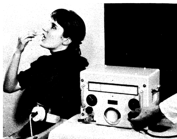
Bild 1. Verschluckbarer Kleinstsender nach Dr. H. G. Nöller mit Pertrix-Endo-Radio-Zelle als Stromquelle
